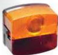
Dreikammerleuchte links, Blink-, Brems-, Schlussleuchte,
