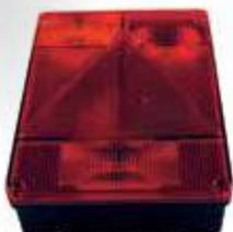
Mehrkammerleuchte links, 6800/10, mit Dreieck-
