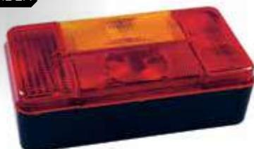
Mehrkammerleuchte links, 5001/10, mit KZL, NSL,
